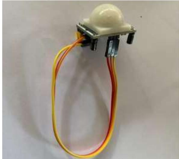
Gambar 5. Rangkaian PIR Sensor
