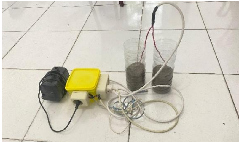
Gambar 2. Kemasan Alat Monitoring Kelembapan Tanah Dan Pompa Air
